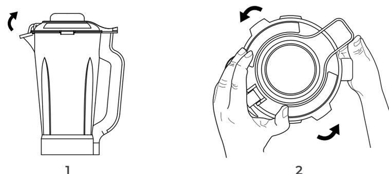
3. Faites glisser l'extrémité arrière du couvercle sur le côté avec le pouce, de sorte que le couvercle ne soit plus relié au bol de mixage.
